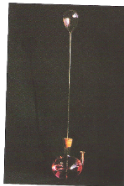
Figure 7.1A Galilée a inventé son thermomètre à air vers 1600. Quand l'air du réservoir supérieur se refroidissait ou se réchauffait, le liquide montait ou descendait dans le tube.
