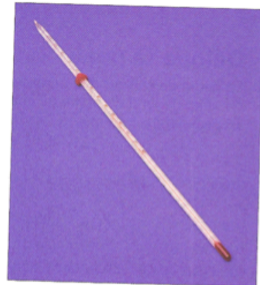
Figure 7.1C Un thermomètre de laboratoire moderne a un plus petit réservoir et une tige de verre à ouverture beaucoup plus étroite.
