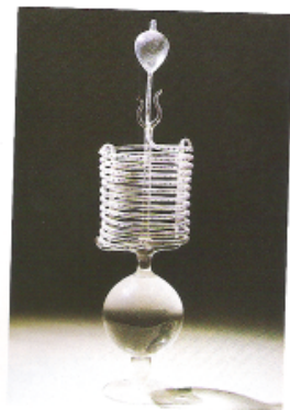
Figure 7.1B On a fabriqué d'autres thermomètres portatifs, comme ce thermomètre à liquide inventé vers 1700, en mettant du liquide dans le réservoir et dans une partie de la tige.
